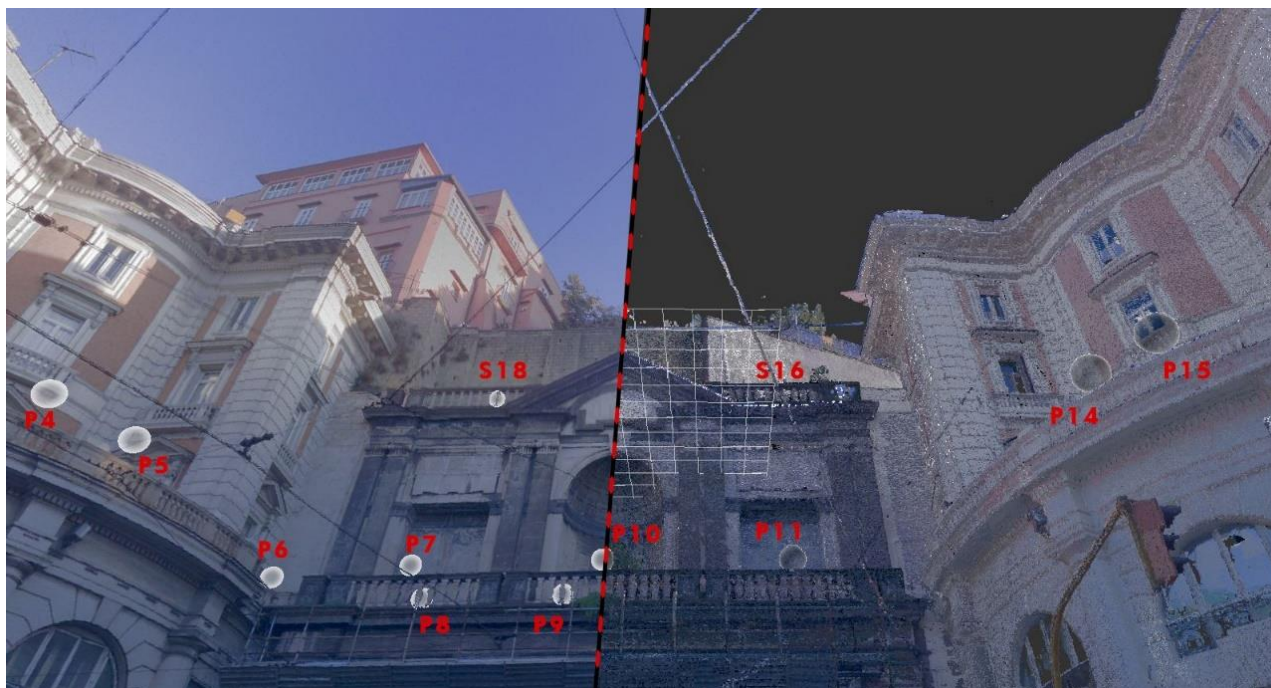
Figura 2 A sinistra uno screenshot dell'immagine panoramica - a destra uno screenshot della nuvola dei punti con proprietà RGB associate
